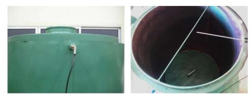
FIGURA 28. Posição do sensor de temperatura para secagem em camada delgada no secador experimental.
