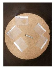
FIGURA 34. Secagem em camada espessa de sementes de soja.
