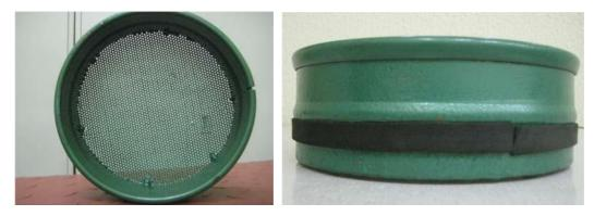
FIGURA 9. Bandeja do leito de secagem em camada delgada.
