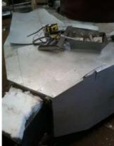
FIGURA 20. Revestimento com isolante térmico na estrutura do secador experimental.
