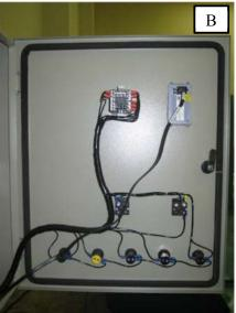
FIGURA 26. Vista interna (A) e da tampa (B) do painel de controle de temperatura e de velocidade do ar de secagem do secador experimental.
