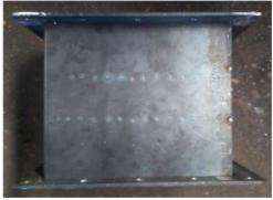
FIGURA 18. Homogeneizador de ar após o conjunto de resistências elétricas.
