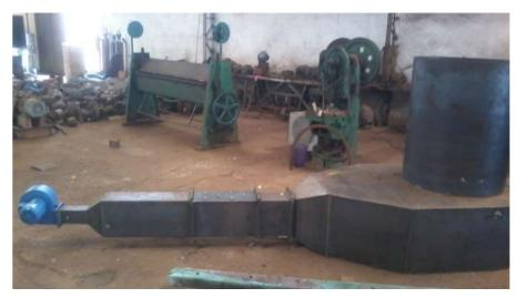
FIGURA 19. Estrutura do secador experimental concluída, ausente apenas o isolamento térmico.
