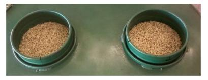
FIGURA 2. Camada delgada de grãos de cártamo disposta nas bandejas do secador.
