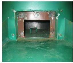
FIGURA 15. Porta para descarregar produto do leito de secagem em camada espessa.
