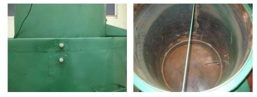
FIGURA 29. Posição do sensor de temperatura para secagem em camada espessa no secador experimental.
