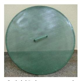
FIGURA 14. Chapa perfurada do leito de secagem em camada espessa.
