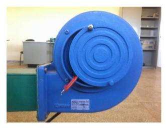
FIGURA 31. Diafragma para regular a entrada de ar no ventilador.
