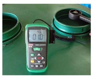
FIGURA 3. Verificação da velocidade do ar nas bandejas de secagem em camada delgada.
